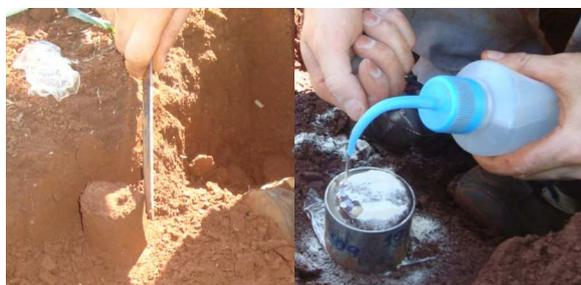
**Figura 2.** Detalhes da coleta de amostras em monolito esculpido no campo.
