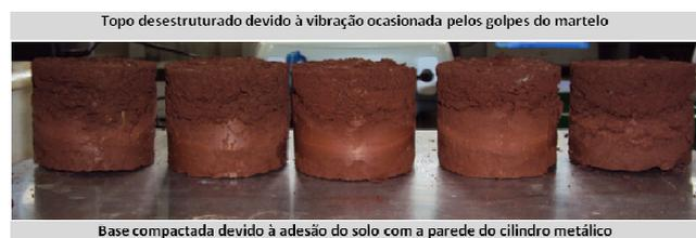
**Figura 1.** Alteração na estrutura do solo provocada durante a coleta de amostras com cilindro metálico
