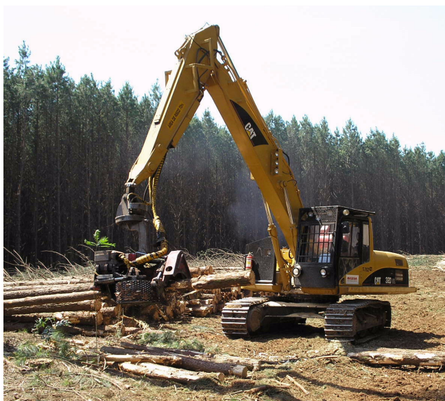
Figura 3 - Escavadeira de esteiras Caterpillar 320 com cabeçote processador Valmet 380.
