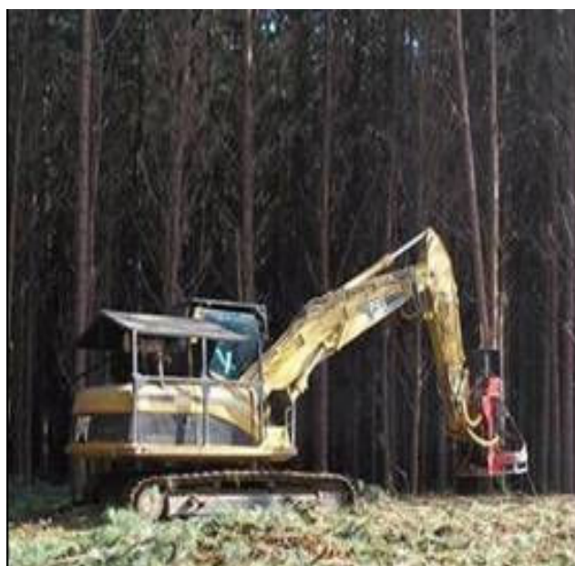
Figura 1 - Escavadeira Caterpillar 320 com cabeçote de Feller de Disco direcional.
