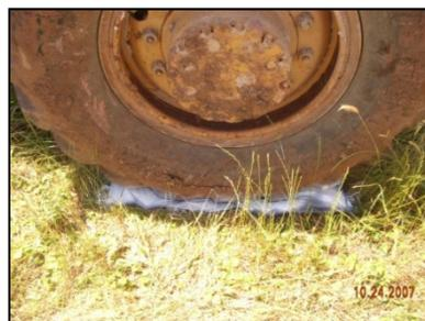
**Figura 4** - Medida da área de contato entre o solo e o pneu.
