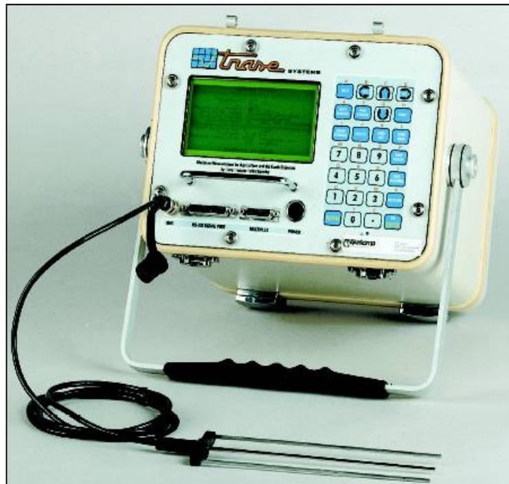
**Figura 7** - TDR – Trase utilizado para fazer as leituras manuais.
