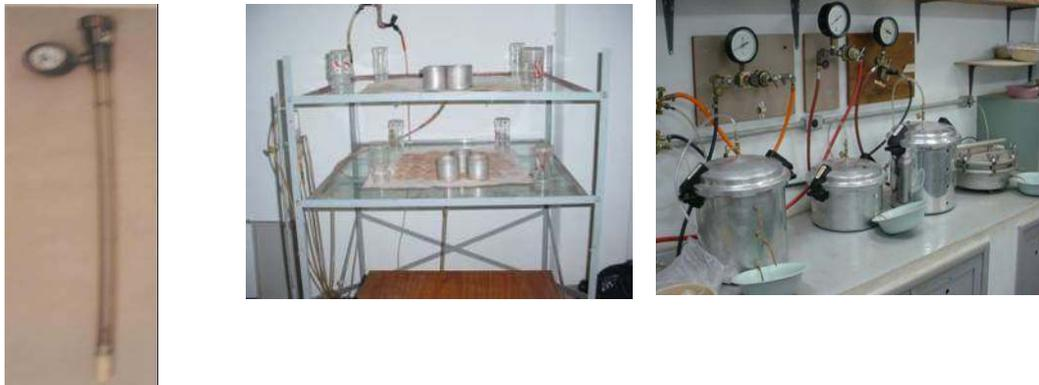
Figura 4.4. Equipamentos usados na determinação do potencial matricial de água no solo: tensiômetro (à esquerda), mesa de tensão (ao centro) e câmaras de pressão (à direita).
