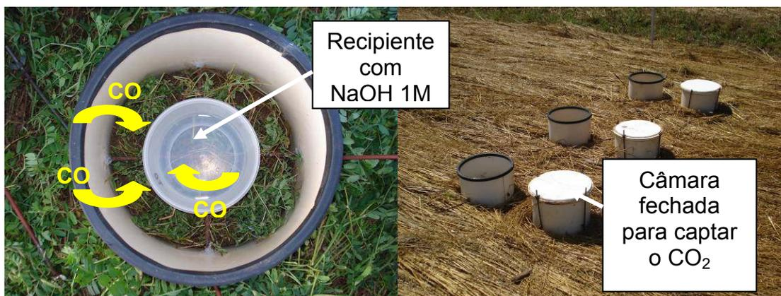
**Figura F.7** Dispositivo utilizado para avaliar a mineralização do carbono em condições de campo.
