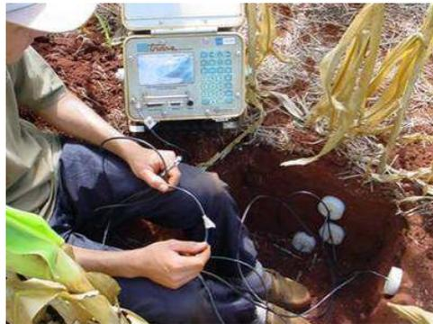
Figura 4.3. TDR sendo instalado no campo para a medição da umidade volumétrica do solo.
