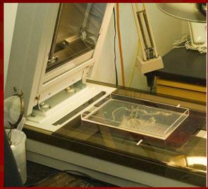
As raízes lavadas são colocadas na bandeja transparente para a digitalização e podem ser acomodadas para reduzir sobreposições e cruzes
