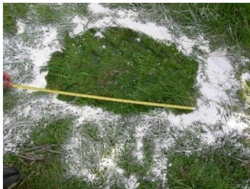
**Figura 3 -Delimitação da área de contato pneu-solo.**
