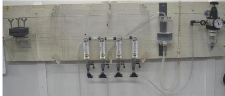
Figura 6 -Permeômetro de carga constante de ar.
