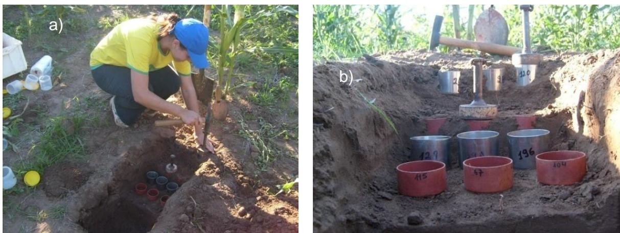
Figura 5 -a) Coleta de amostras de solo, b) Cilindros, extratores e martelo na trincheira de coleta.
