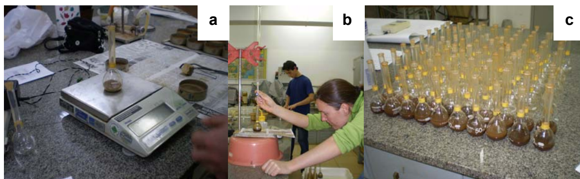
Figura 13 - Determinação da densidade de partícula pelo método do balão volumétrico modificado, sendo a pesagem (a), a aferição com álcool etílico (b) e os balões com solo e álcool etílico (c).
