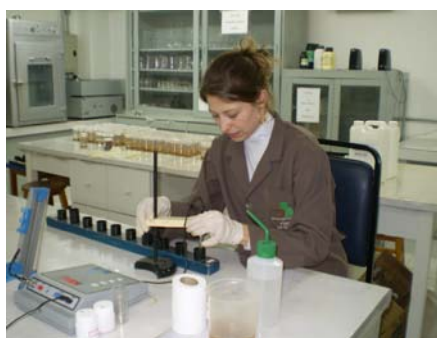
Figura 12 - Análise química do solo (leitura de \text{pH}_{\text{água}} e índice SMP).
