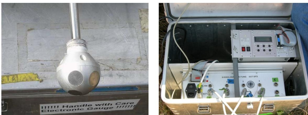
Figura 34 – Sensor do SST3 e o datalogger analógico.
